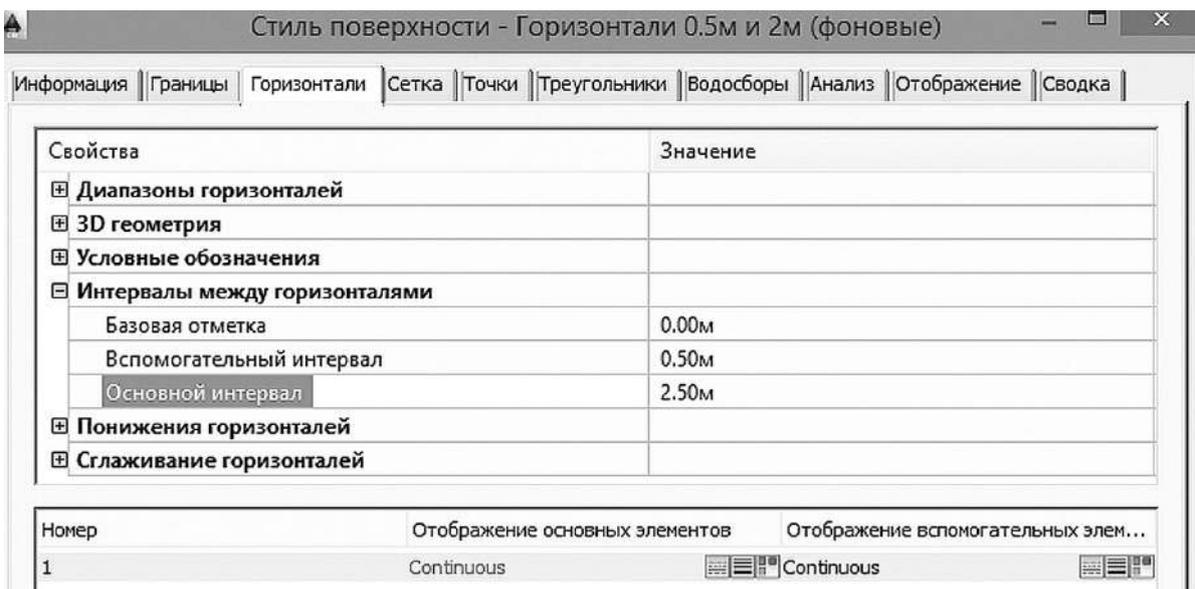
Рис. 1.23. Назначение интервала между горизонталями
